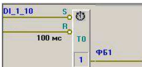
Тип 1 - «Задержка включения с запоминанием»
